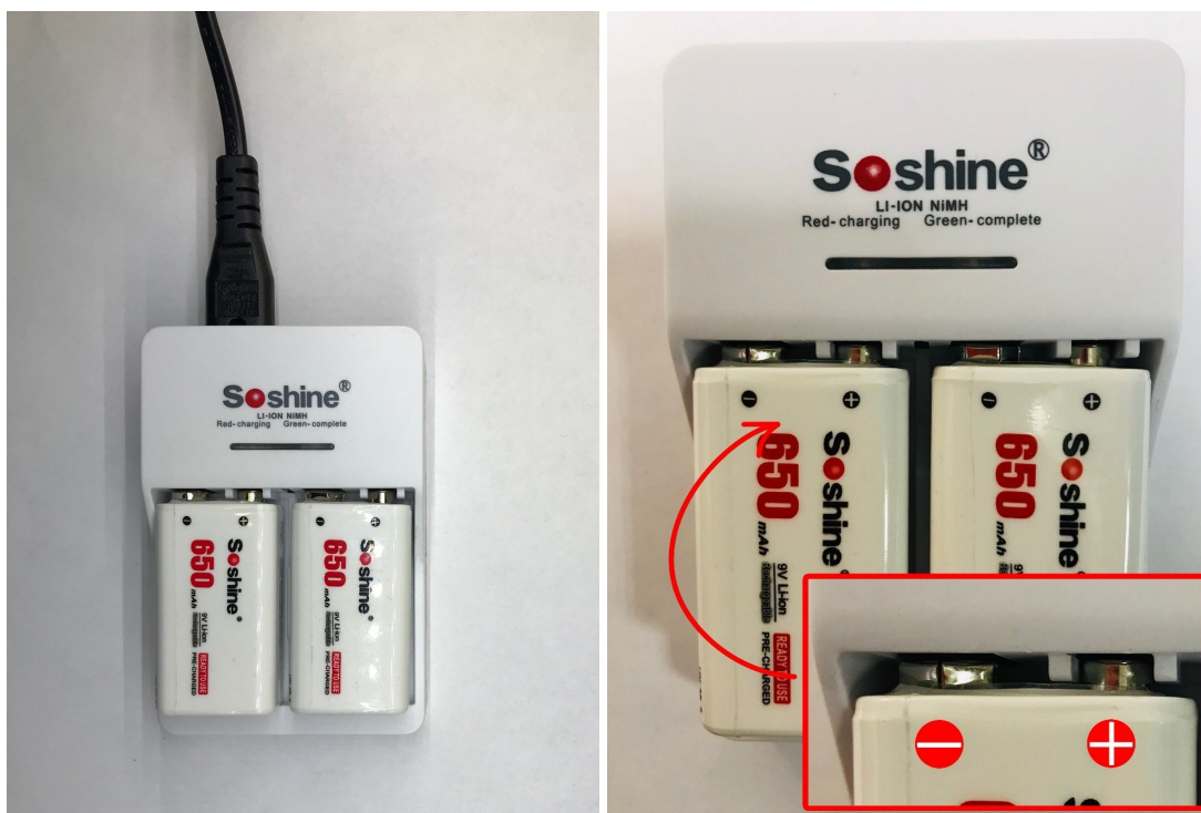
Рис. 1 - Зарядное устройство с подключенным к нему проводом питания и двумя вставленными аккумуляторами
