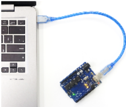
Пример НЕПРАВИЛЬНОГО подключения (отсутствует гальваноразвязка):
